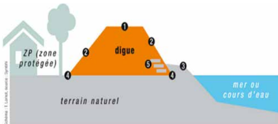
❶ Crête de digue supportant généralement une piste. ❷ Talus de digue : talus aval côté ZP, talus amont côté eau. ❸ Berge. ❹ Pied de digue. ❺ Protection anciennes : perré, lauzes...
